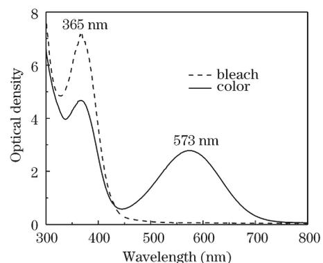
Fig. 1. Absorption spectra of the pyrrolyfulgide/PMMA.
